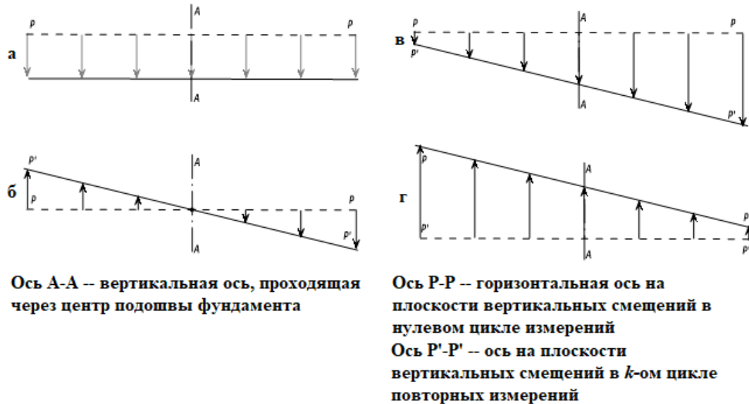
Рисунок 9.1 – Схема влияния осадки (подъема) и крена на положение линии разреза в плоскости вертикальных смещений при а – при равномерной осадке \Delta H_{i,кр} = 0 ; б – при крене \Delta H_{i,oc} = 0 ; в – при неравномерной осадке \Delta H_{i,кр} \neq 0 и \Delta H_{i,oc} \neq 0 ; г – при неравномерном подъеме \Delta H_{i,кр} \neq 0 и \Delta H_{i,oc} \neq 0
